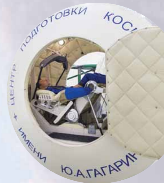
Центрифуга ЦФ-7 моделирует перегрузки на спуске космического корабля с орбиты
