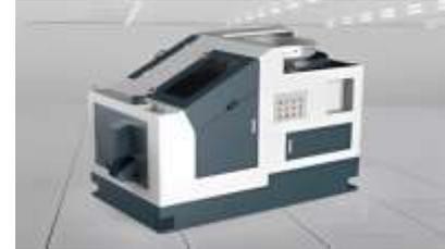
Производство изделий методом объёмной штамповки деталей без предварительного нагрева заготовки (холодная высадка):
