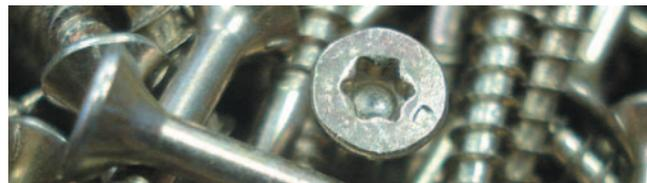
**Саморезы универсальные SPAX.** Применяются в дереве, пластмассе, металлическом тонком листе. Многогранная головка Multi: специально для дерева и металлических обшивок. Запатентованный волнообразный профиль: Быстрая и простая обработка, мягкий режим в соответствии с видом материала. Четырехгранный конический конец 4CUT: отсутствие расщепления даже на незначительных расстояниях от края, мгновенный захват без предварительного сверления.
