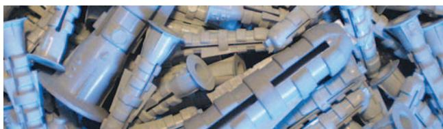
**Анкера.** Анкер – это крепежное изделие состоящее из гильзы и крепежной детали, которая расширяет гильзу для образования надежного крепления. Применяются анкеры для крепежа в твердых основаниях. В роли крепежной детали могут использоваться: болты, винты, шпильки, шурупы, гвозди.
